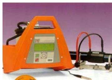
Para a união de tubagens de PEAD pode optar-se tanto pela soldadura topo a topo como pela electrosoldadura. O critério de selecção deve ser determinado de acordo com a configuração da obra, os diâmetros e pressões a empregar e a disponibilidade dos equipamentos necessários.
